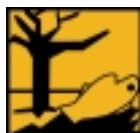
Peligroso para el entorno
